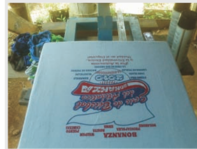
2do. paso Imprimir el segundo color
