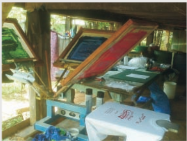
Máquina innovada en Bza. para imprimir 4 colores
