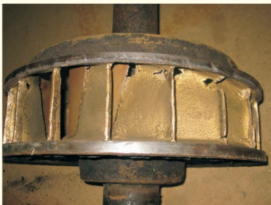
Rodete de la turbina averiado
