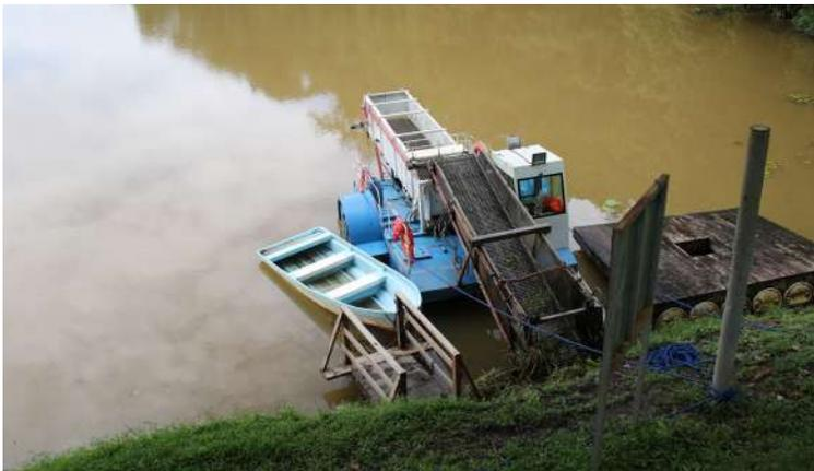
Con el interés de ampliar la capacidad de acumular agua en la presa hidroeléctrica, Salto Grande, HEMCO realizó un proyecto de inversión de aproximadamente cien mil dólares. Esto incluyó la puesta en marcha de una cortadora y recolectora de maleza acuática para proceder con la limpieza de la presa.
